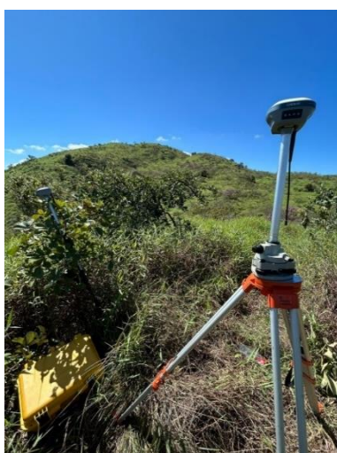
Foto 13 Base topográfica nivelada
