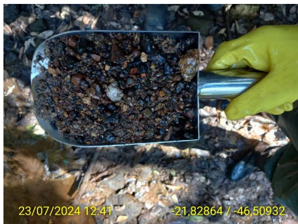
Foto 173 Amostragem de Sedimentos no Ponto SED-14 - Período de Seca
