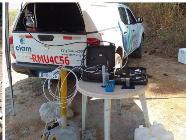
Foto 217 Amostragem de Águas Subterrâneas no Ponto SUB-12 - Período de Seca
