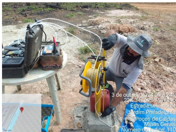
Foto 203 Amostragem de Águas Subterrâneas no Ponto SUB-01 - Período de Seca
