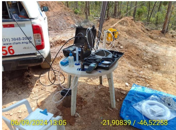
Foto 206 Amostragem de Águas Subterrâneas no Ponto SUB-03 - Período de Seca
