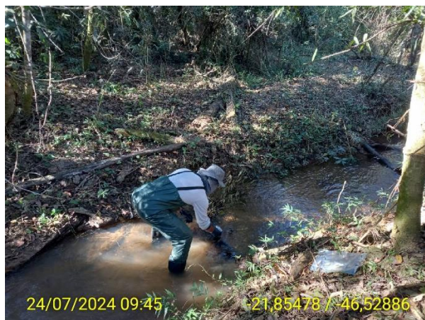
Foto 127 Amostragem de Águas Superficiais no Ponto SUP-04 - Período de Seca
