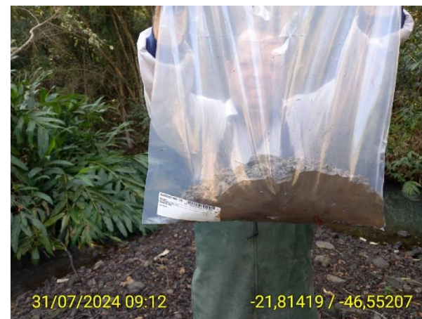
Foto 163 Amostragem de Sedimentos no Ponto SED-09 - Período de Seca
