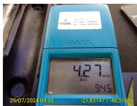
Foto 202 Turbidímetro utilizado em campo Autor: Clam, 2024
